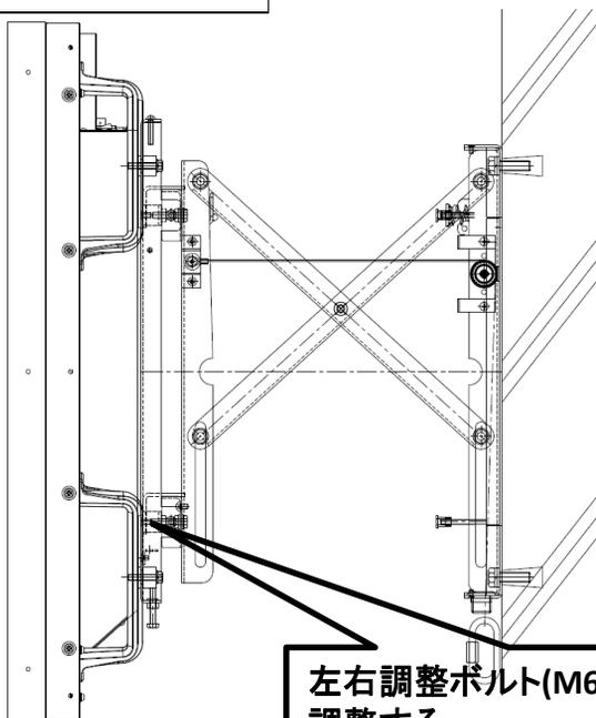
左右調整ボルト(M6)四隅4点で調整する。
